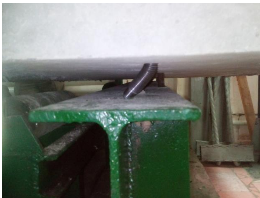
Рис. 5 – Втрата стійкості регулюючого болта типу БР плити БМП-КРМ при граничному навантаженні на стенді
